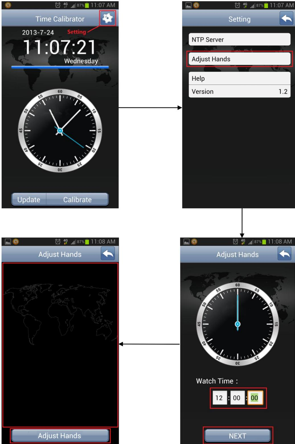
Imagen 2-3-3 “Ajustar agujas” operación a través del software del smartphone
